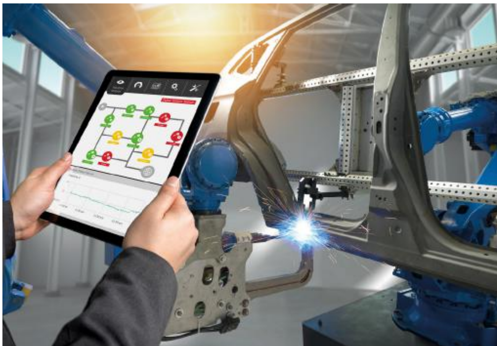
FIG. A1.7 ► Monitoraggio delle vibrazioni in tempo reale tramite tablet in una tipica lavorazione da Industria 4.0
